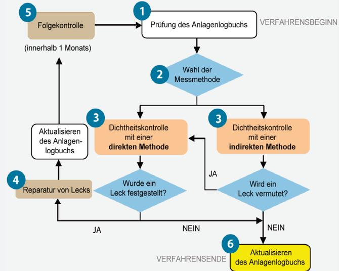
Die Schritte 1 bis 3 müssen immer durchgeführt werden. Wenn kein Verdacht auf Lecks besteht (indirekte Messmethoden) oder keine Lecks festgestellt werden (direkte Messmethoden), wird das Verfahren durch Aktualisieren der Aufzeichnungen über die Einrichtungen (Anlagenlogbuch) im 6. Schritt beendet.
